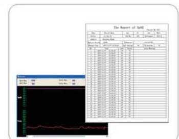
Permet le stockage de 100 ID et de 300 heures de données de surveillance continue, qui peuvent être transférées sur PC à des fins d'archivage, d'impression et de consultation
