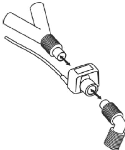
Connexion de l'adaptateur du circuit d'air
