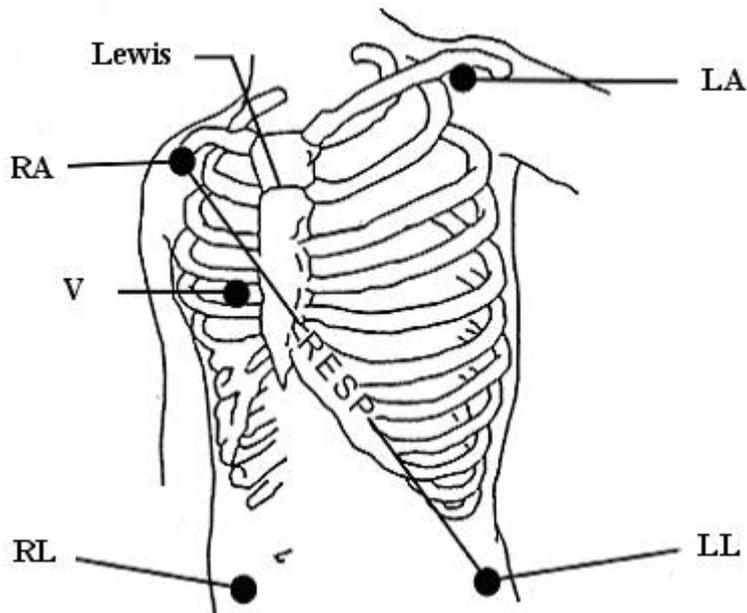
Positionnement des électrodes pour 5 dérivation
