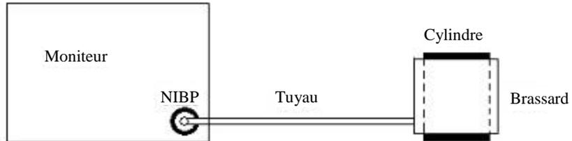
Schéma du test de fuite du circuit d'air pour la fonction NIBP
