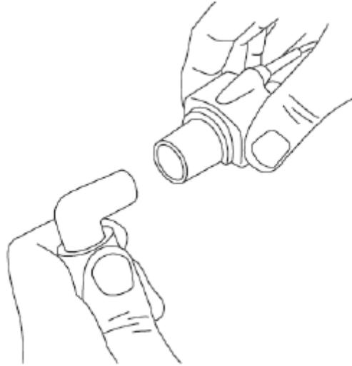
Vous pouvez également brancher un échangeur de chaleur et d'humidité entre le tube endotrachéal du patient et la sonde IRMA. Grâce à l'insertion d'un échangeur de chaleur et d'humidité avant la sonde IRMA, l'adaptateur circuit d'air est protégé contre les sécrétions et les effets de la vapeur d'eau ; il n'est pas nécessaire de remplacer l'adaptateur. Une telle configuration permet également de positionner librement la sonde IRMA.
