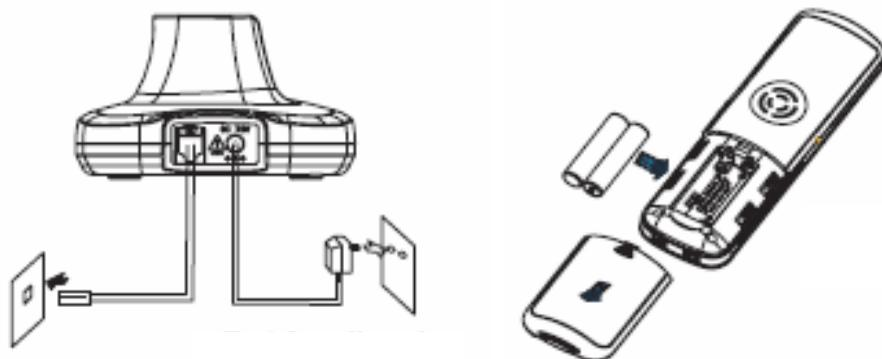
Insérez des piles rechargeables dans le combiné. Pour le combiné, vous aurez besoin de deux piles rechargeables format AAA NiMH. Ces piles sont fournies avec l'appareil. Faites coulisser le couvercle du compartiment des piles dans le sens de la flèche, jusqu'à ce qu'il soit complètement dégagé. Assurez-vous de respecter la polarité lorsque vous mettez les piles dans le combiné. Remettez en place le couvercle du compartiment des piles à l'arrière du combiné, en le faisant coulisser à fond.
