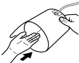
**Remarque :** Si le brassard n'est pas assemblé, passer l'extrémité du brassard la plus éloignée du tuyau dans l'anneau métallique en D afin de former une boucle. Le vêtement doit être pris dans la boucle du brassard.
