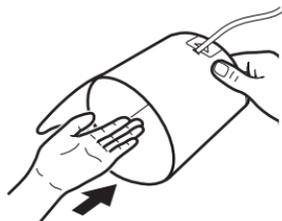
**Remarque :** Si le brassard n'est pas assemblé, passer l'extrémité du brassard la plus éloignée du tuyau dans l'anneau métallique en D afin de former une boucle. La bande de tissu doit être prise dans la boucle du brassard.
