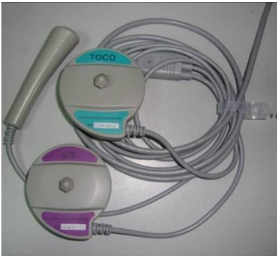
Sonde 3-en-1 Sonde FHR probe Sonde de contractions utérines Marqueur de mouvements foetaux
